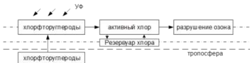
Рис. 3. Механизм разрушения молекул озона ХФУ
