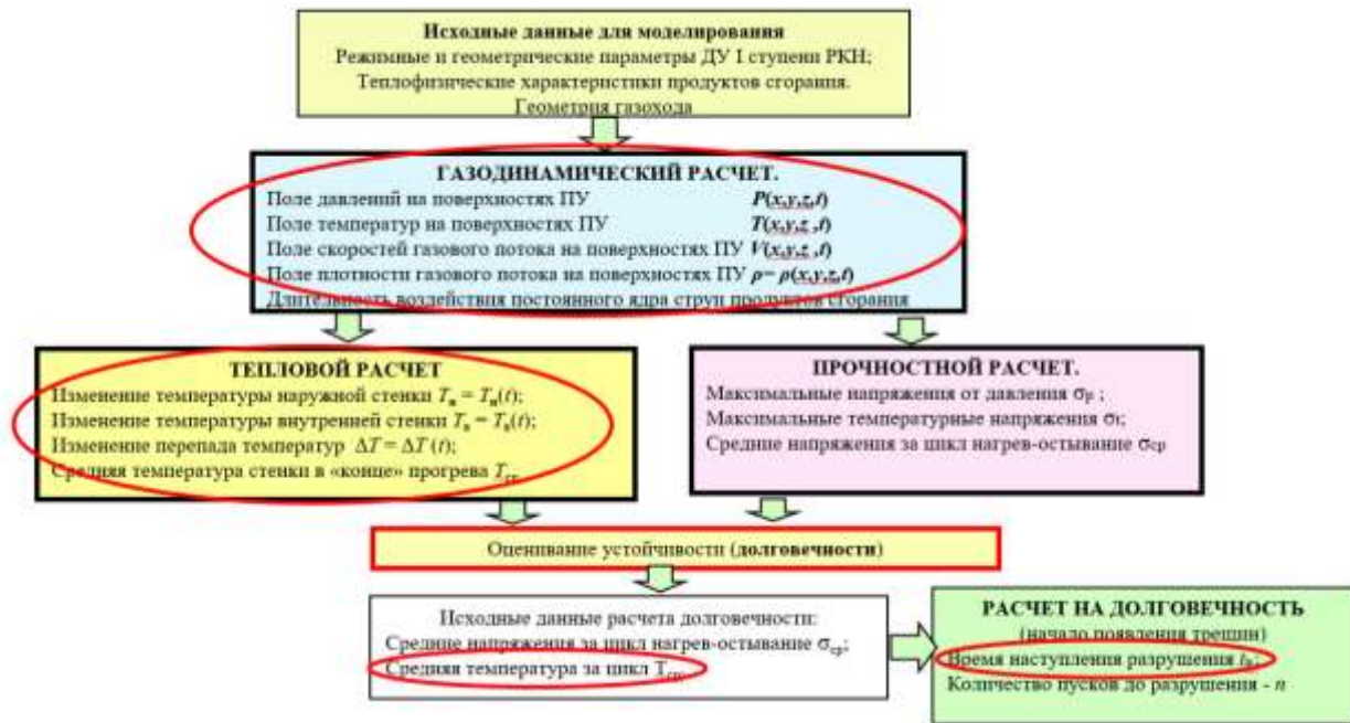
Рис. 1. Схема оценивания состояния газохода пускового стола
