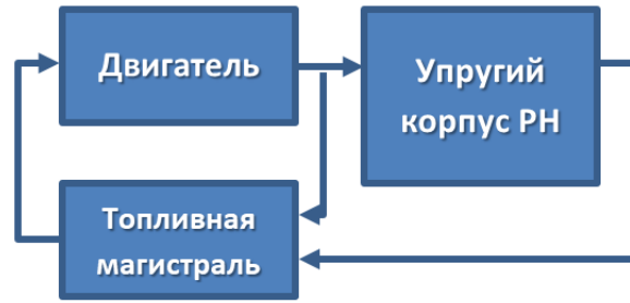
Рис. 1. Схема автоколебательных контуров при продольных колебаниях РКН
