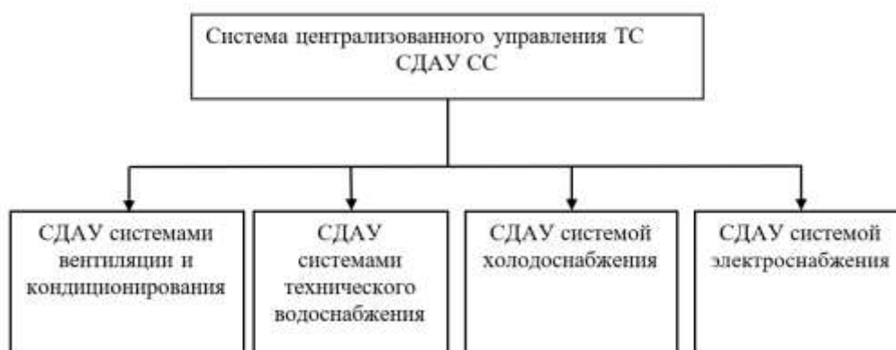
Рис. 1. Структурная схема СДАУ СС
