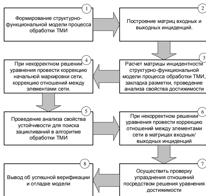
Рис. 1. Структура методики верификации и отладки алгоритмов обработки ТМИ
